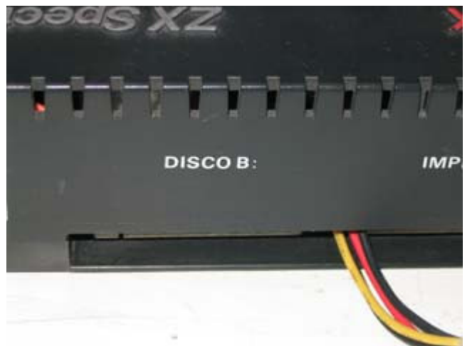
Imagen 9. Conector de segunda disquetera en el +3
