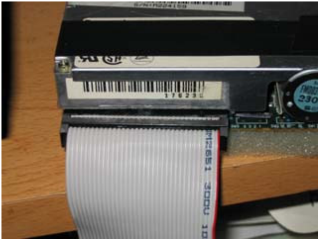
Imagen 10. Conexión del cable de datos a la disquetera
