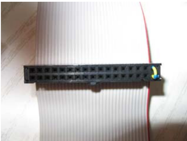
Imagen 11. Puente entre los pines 1 y 2
