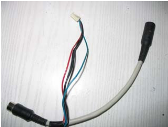
Imagen 7. Ladrón de alimentación para la disquetera del +3
