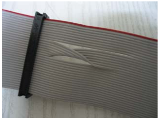
Imagen 8. Parte cruzada de la faja de datos de la disquetera
