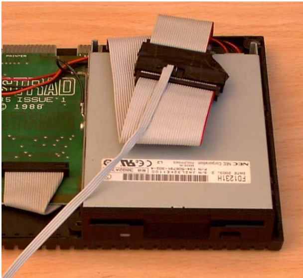
Figura 15. Disquetera 3.5 pulgadas con todas las conexiones
