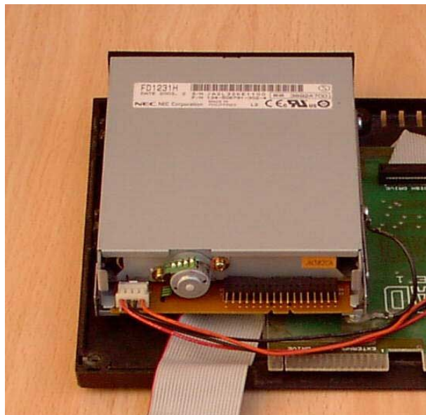
Figura 9. Alimentación de la disquetera
