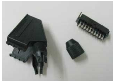
Imagen 1. Clavija SCART hembra aérea
