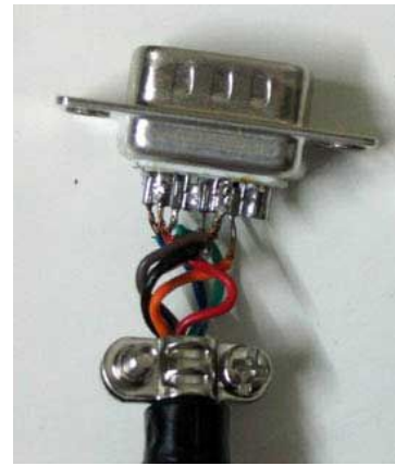
Imagen 2. Detalle de las soldaduras en la clavija DB9
