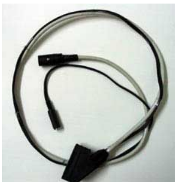
Imagen 5. Adaptador RGB para monitor CTM644
