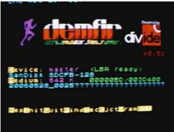
En este caso es una Sandisk@ 128MB. Sector de arranque en la dirección 00000DB. Si no ponemos un nombre válido, divide anota la fecha y la hora del archivo *.iso
