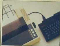
Standart yazıcılar ZX Interface 1 aracılığıyla bağlanır.
