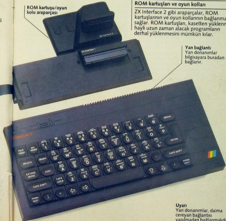
Standart yazıcılar ZX Interface 1 aracılığıyla bağlanır.
