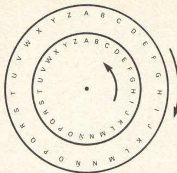
Fig. 6. Para realizar el método de codificación por transposición se pueden utilizar dos discos de cartón unidos por el centro y capaces de girar uno sobre otro.
