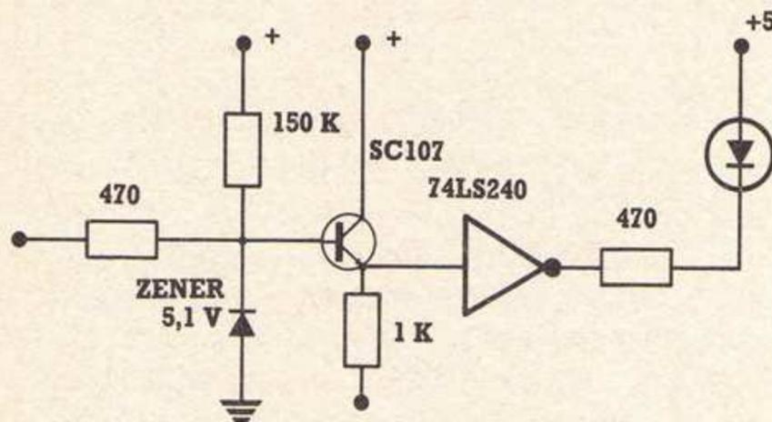
Fig. 7. Sonda con amplificación y protección.
