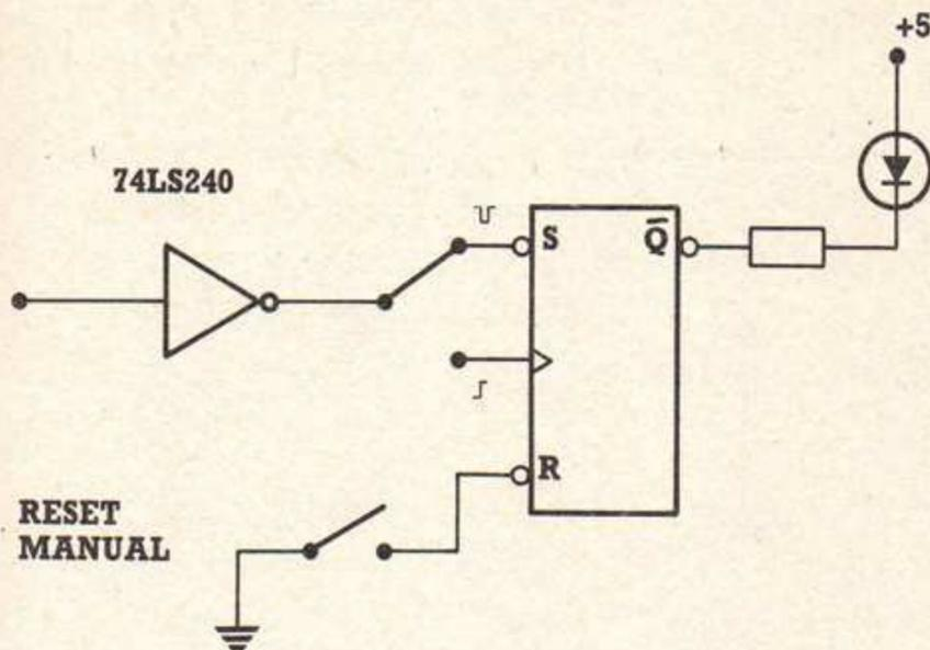
Fig. 10. Sonda con retención.
