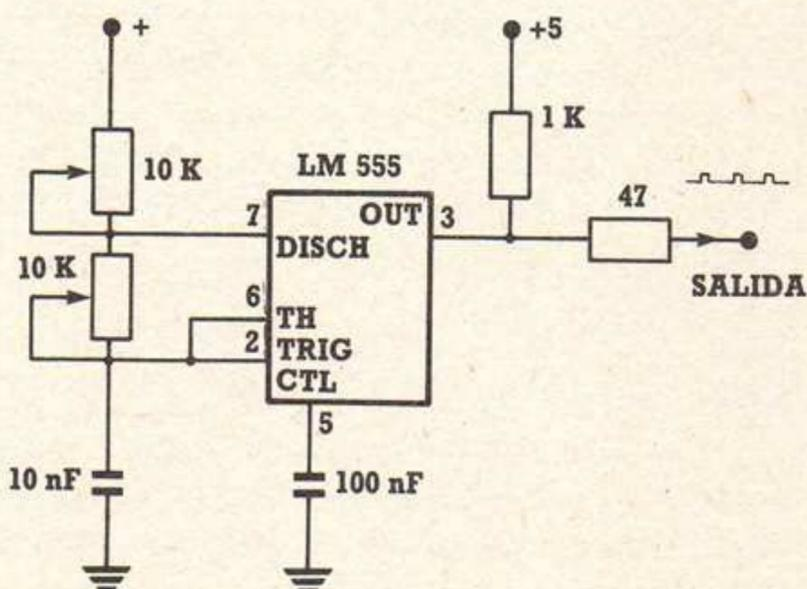
Fig. 11. Generador de señales TTL.
