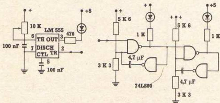
Fig. 8. Sonda de transiciones.
