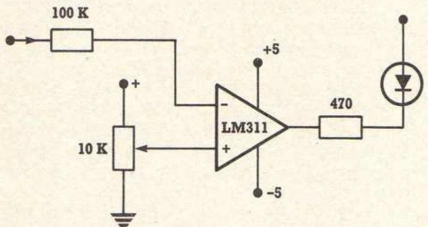
Fig. 9. Sonda de nivel variable.
